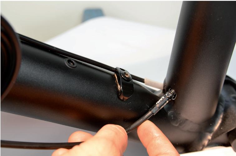
Nun kann die Leitung der Sattelstütze eingefädelt und mit Liteville Triple Cable Holdern\* am Rahmen fixiert werden. Fertig.
