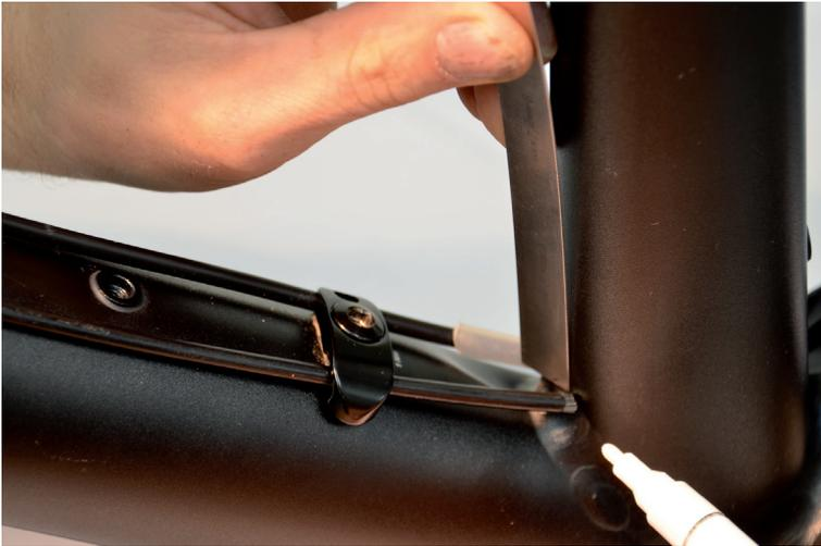
Das Loch für die Bohrung muss in der Flucht der untersten Kabelbefestigungsklemme und ca. 3 mm über der Schweißnaht angezeichnet werden.
