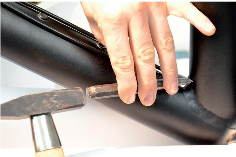
Vor dem Bohren einen Körner verwenden, um ein Abrutschen beim Bohren zu vermeiden.
