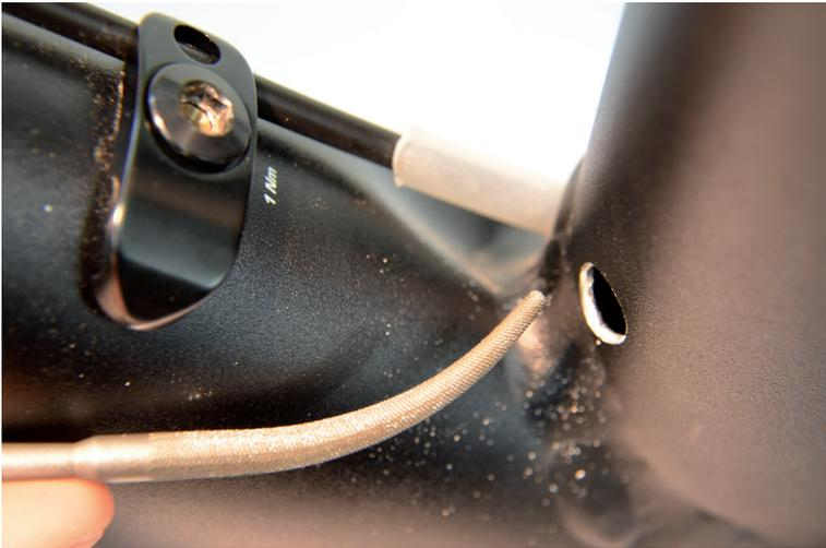
Nach dem Bohren ist es wichtig, dass das Loch innen und außen am Besten mit einer Löffelfeile sauber entgratet wird. Vor allem der obere Bereich ist sehr wichtig, weil die Leitung dort mit dem Rahmen in Berührung kommt und bei nicht sauberer Entgratung aufgescheuert werden kann.
