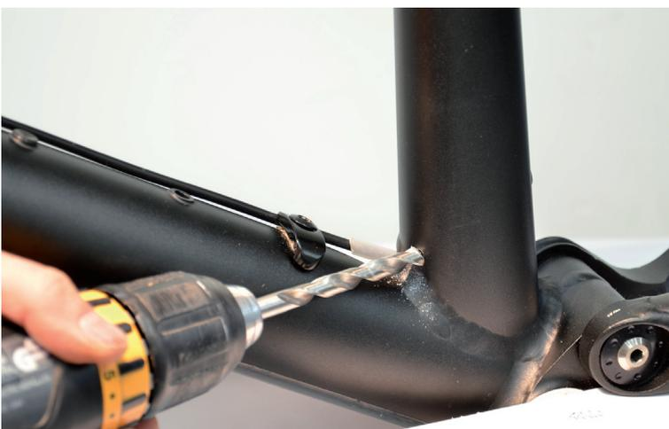
Anschliessend mit einem 8 mm Bohrer mit wenig Druck aufbohren. Die Loch-Unterkante sollte idealerweise 1-2 mm in die Schweißnaht hineinragen.
