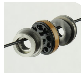
Kolbenbaugruppe wieder zusammengebaut
