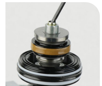
Kolbenbaugruppe eingebaut
