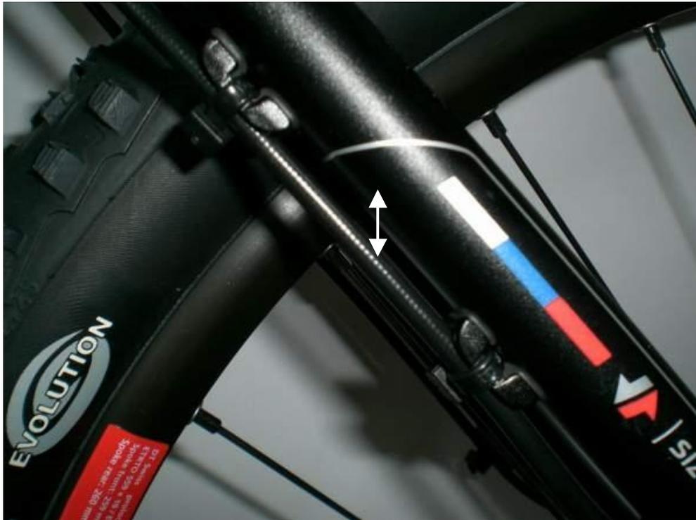
Die Befestigung der Discleitung an der Sitzstrebe muss mit Kabelbinder erfolgen, um ein verschieben zu verhindern!
