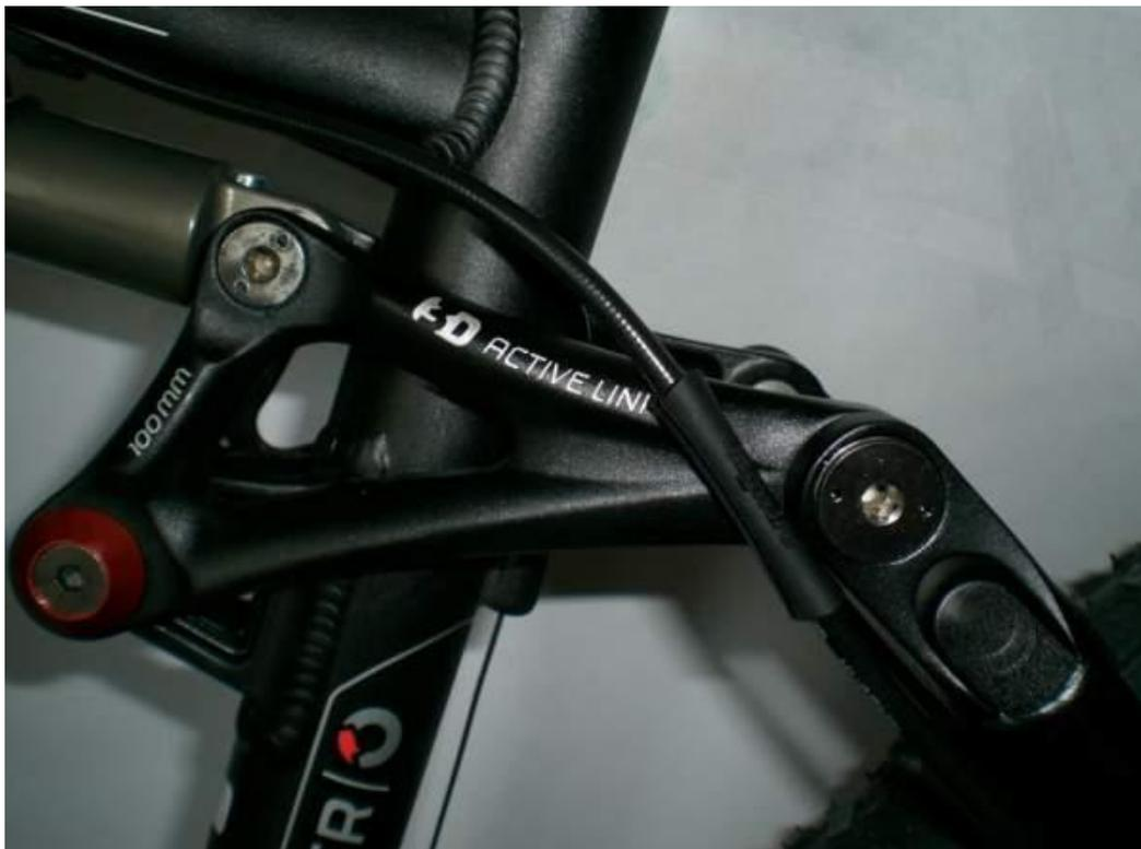
Die Zugverlegung des Umwerfers verläuft am Unterrohr mittig und wird dann links am Sattelrohr in einem sauberen knappen Bogen bis zu Zuganschlag geführt. Die Außenhülle wird dabei so kurz geführt, das sie knapp 1cm über dem Umlenkhebel verläuft (siehe Bilder).
