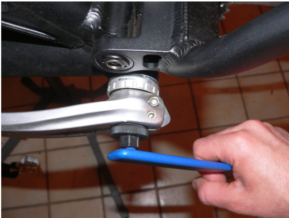
Kunststoffschraube herausdrehen und linke Kurbel abziehen
