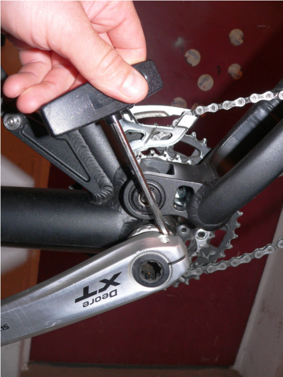
Klemmschrauben an linker Kurbel lösen
