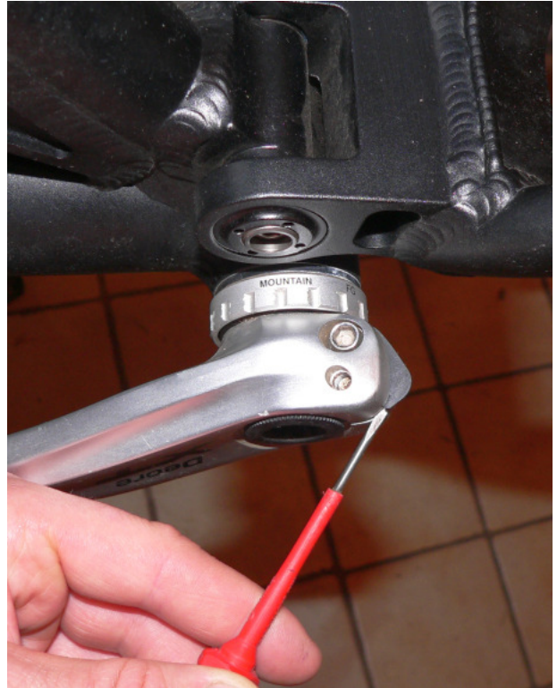
Sicherungsblättchen herausklappen
