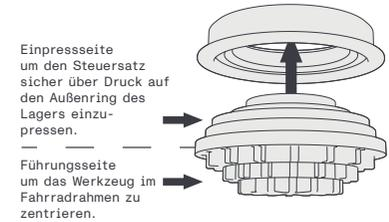
Einpressseite um den Steuersatz sicher über Druck auf den Außenring des Lagers einzupressen.
