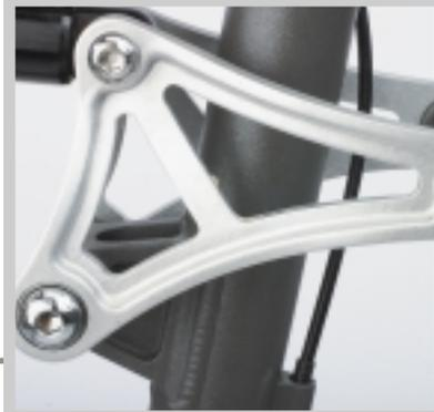
*Der Dämpfer am Viergelenk-Hinterbau wird über eine hochwertig gefertigte Wippe angelenkt. Die neue Hinterbau-Konstruktion sorgt für angenehme Ruhe im Fahrwerk.*
