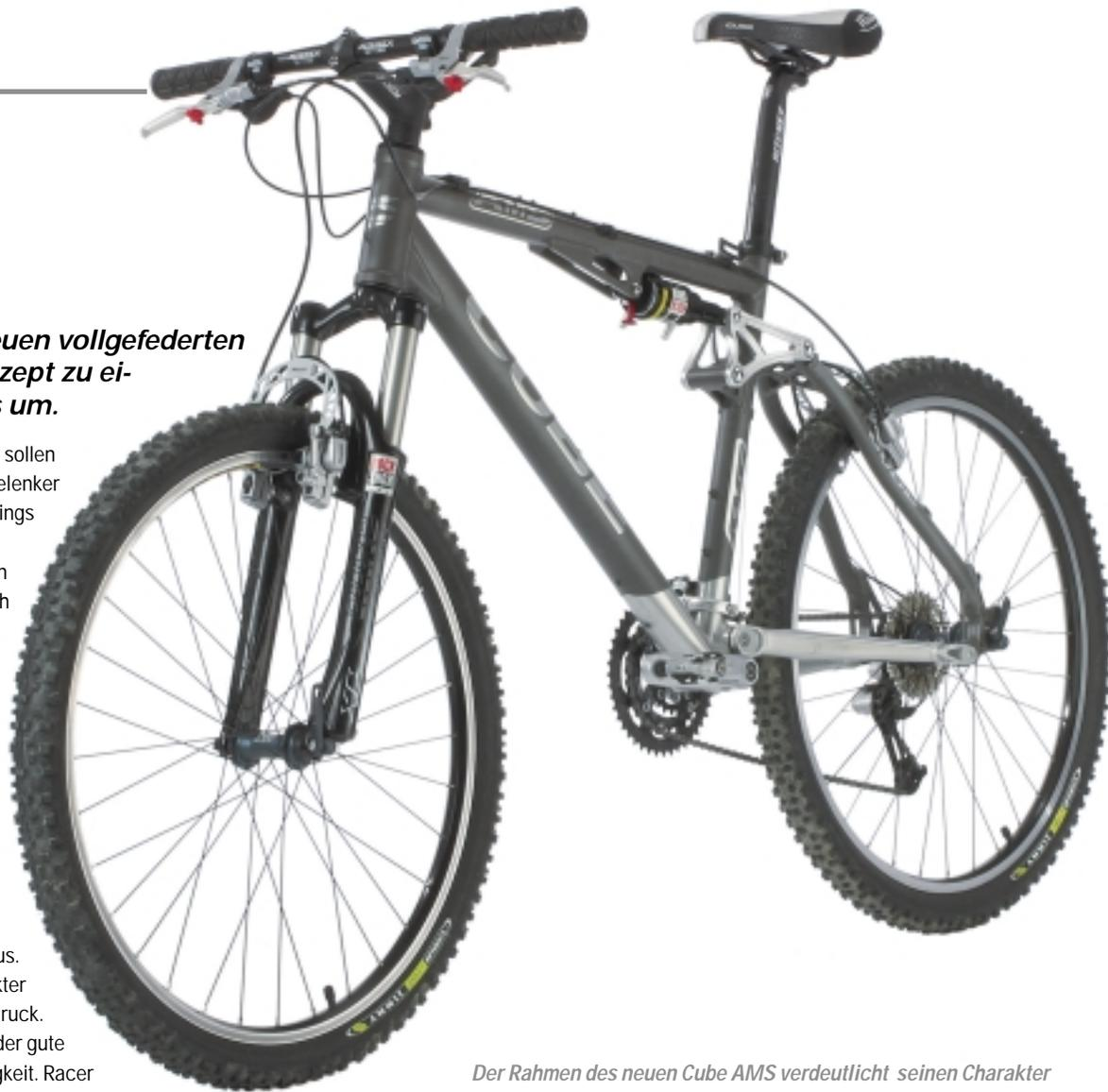
*Der Rahmen des neuen Cube AMS verdeutlicht seinen Charakter – das lange Oberrohr sorgt für eine sportliche Sitzposition und jede Menge Vortrieb. Ästheten freuen sich über den aufwendig angebrachten Schriftzug am Unterrohr.*
